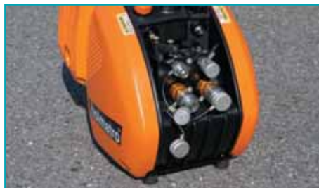
replace dust caps
